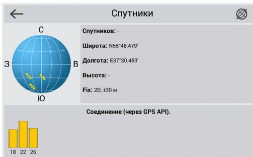
В левой верхней части окна расположено схематическое изображение сферы небосвода с указанием сторон света. Центр полусферы соответствует зениту, ее окружность обозначает линию горизонта. При активированной функции связи со спутниками на полусфере отображаются спутники условными знаками желтого и зеленого цвета. Зеленый цвет обозначает более высокое качество приема сигнала, желтый – более низкое.
