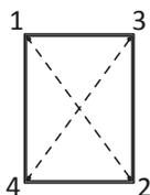
Начать забивать гвозди в последовательности, указанной на схеме. Продолжить с интервалом 10-15 см, отступая 4 мм от края ДВП. То же для задней стенка комода (пункт 5Б)
