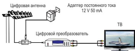
**Установка 2.** Подключение непосредственно к ТВ высокой четкости
