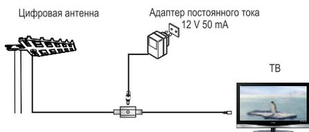
*Примечание: после завершения монтажа и установки антенны отрегулируйте антенну так, чтобы она находилась в оптимальном положении*
