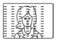
**Изображение с кривыми линиями и дрожит**. Обычно это вызвано электромагнитным излучением работающих вблизи приборов (фенов, мобильных телефонов, радиоприемников или радиопередатчиков).
