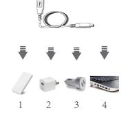
Вы можете заряжать батарею ирригатора от портативного аккумулятора (1), от обычной электрической розетки (2) (адаптер питания в комплект поставки не входит), в автомобиле (3) (адаптер питания в комплект поставки не входит), от USB-порта компьютера или другого устройства (4).
