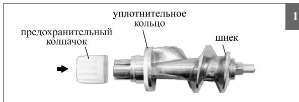
Предохранительный колпачок защищает механизм электромясорубки от поломки. При случайном попадании в процессе переработки в приставку-мясорубку костей и других твердых предметов, а также при перегрузках привода электромясорубки, вызванных нарушением правил эксплуатации изделия, предохранительный колпачок разрушается, шнек перестает вращаться, а привод продолжает работать в режиме холостого хода.
